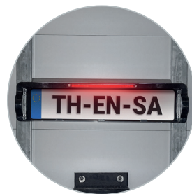
Derde remlicht LED in kentekenhouder
