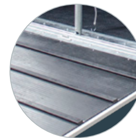
Hayon d'accès bas avec bords en caoutchouc, barres transversales et butées latérales
