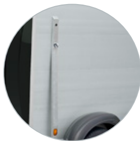
Panneaux latéraux en aluminium avec support
