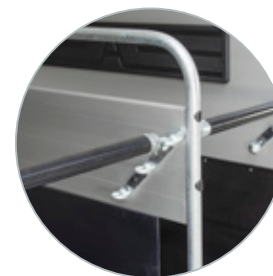
Verstellbare Boxenstangen (vorne und hinten)
