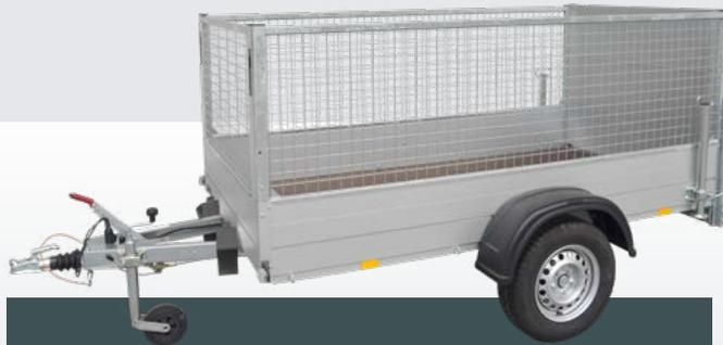
Gitteraufsätze mit einer Höhe von 70 cm sorgen für noch mehr Ladevolumen. Hier in Kombination mit einer Auffahrrampe abgebildet.
