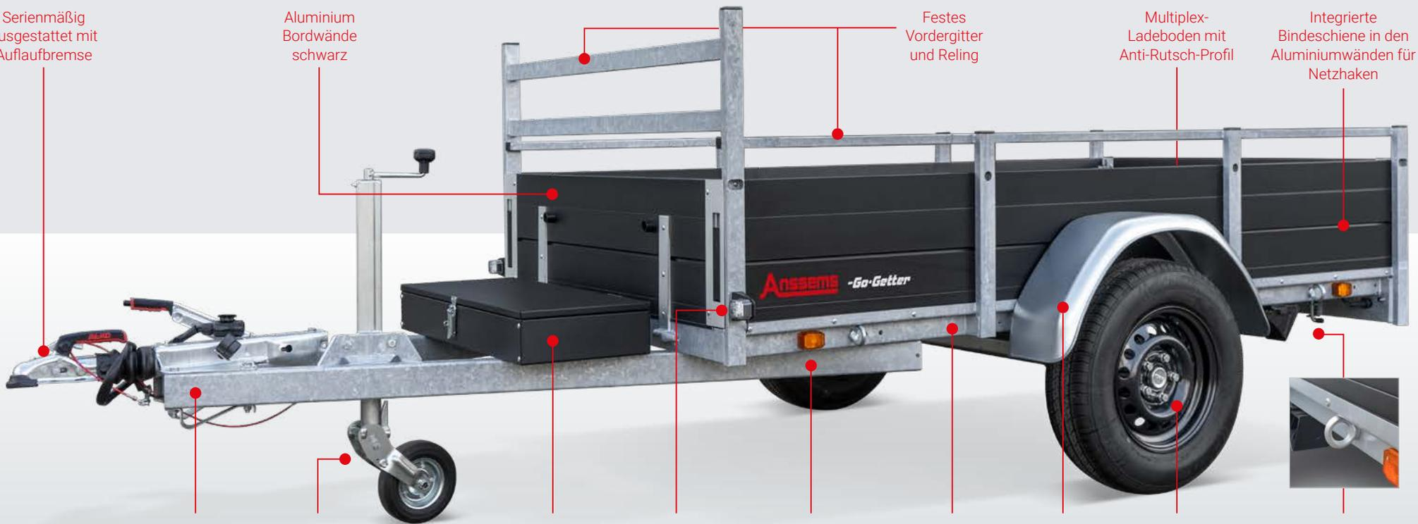
Lange Deichsel aus Rechteckrohrprofil mit einer freien Länge von 145 cm
