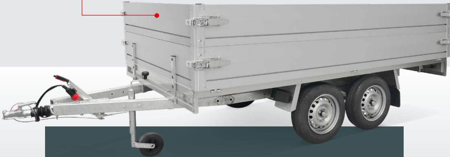
Benötigen Sie zusätzliches Ladevolumen? Durch die Montage von Aufsatzbordwänden erhöht sich die Seitenaufbauhöhe auf 60 cm.
