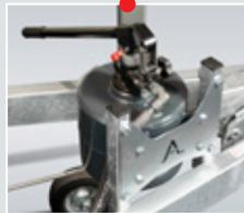
Schutzabdeckung über Pumpe und Batterie
