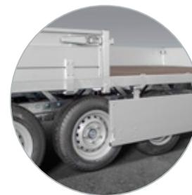
Geteilte Seitenwände ab 5 Metern Länge
