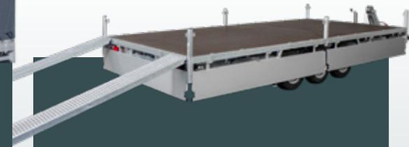
Sie können die Bordwände leicht demontieren und den Medax als flachen Plattformwagen nutzen.
