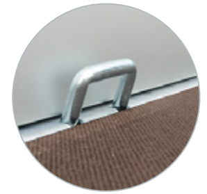
8 Bindehaken an der Innenseite der Ladeplattform
