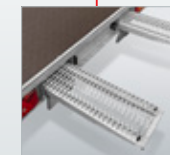
Unterm Ladeboden integrierte Auffharrampen
