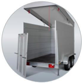
Die Aluminium-Heckklappe ist leicht zu (de-)montieren
