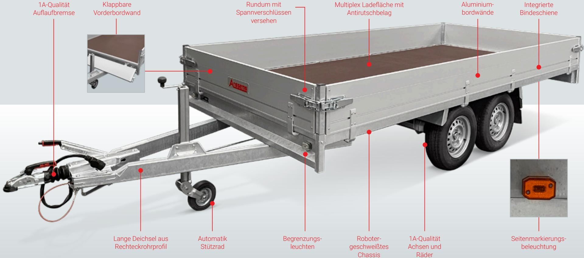
Lange Deichsel aus Rechteckrohrprofil
