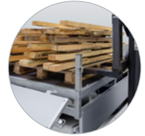
Bordwände klappen bis unter die Ladefläche. Beschädigungsfreies Be- und Entladen
