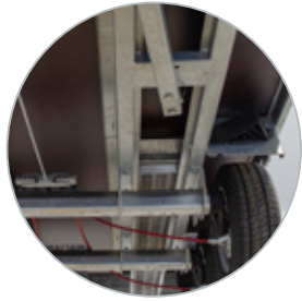
Starker Rahmen mit integrierter Auffahrrampenhalterung
