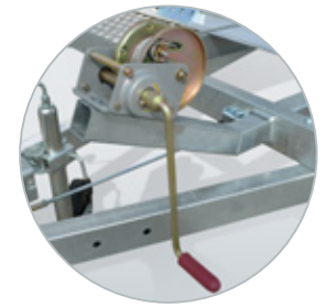
Seilwinde mit Halter ist optional
