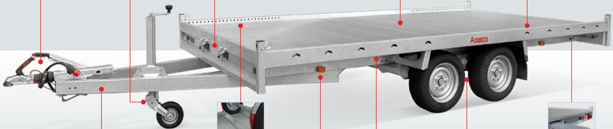
Lange Deichsel aus Rechteckrohrprofil mit einer freien Länge von 145 cm
