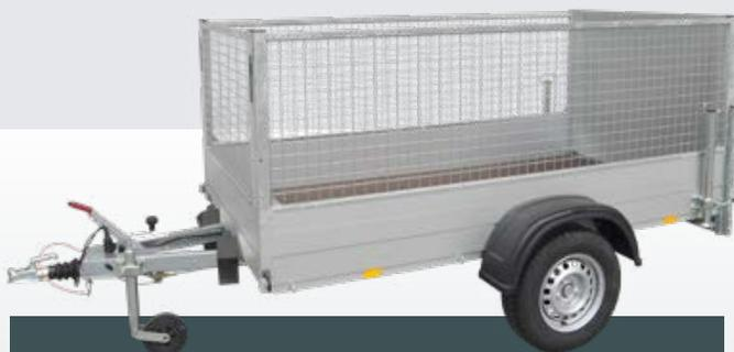
Gitteraufsätze mit einer Höhe von 70 cm sorgen für noch mehr Ladevolumen. Hier in Kombination mit einer Auffahrampe abgebildet.
