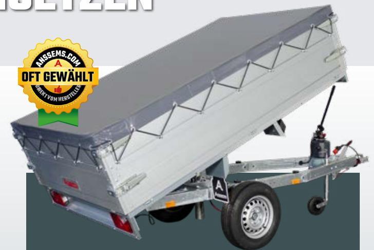
Mit den 30 cm Aufsatzbordwänden können Sie eine Ladehöhe von 60 cm erreichen. Die Flachplane ist einfach zu montieren, auch in Kombination mit Aufsatzbordwänden.
