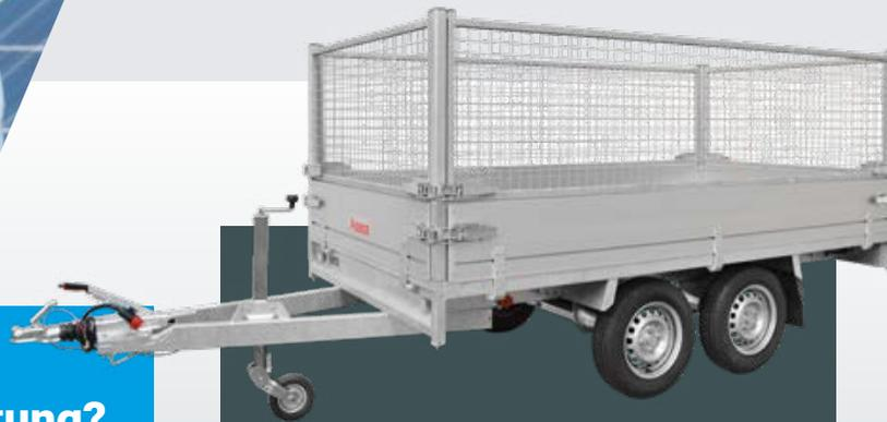
Mit den Gitteraufsätzen schaffen sie zusätzliches Ladevolumen. Diese 70 cm hohen Aufsätze werden auf die 30 cm hohen Standardbordwände gesteckt.
