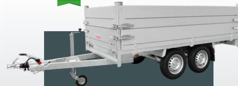
Zusätzliche Lademöglichkeiten durch Montage der Aufsatzbordwände mit einer Höhe von 35 cm.
