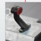
Feux de gabarit à l'arrière
