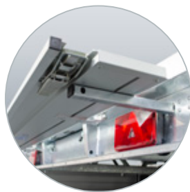
Supports de ridelle à l'arrière avec des manchons
