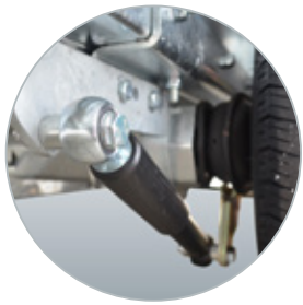
Zubehör; Achsstoßdämpfer für zusätzlichen Fahrkomfort
