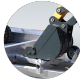
Serienmäßig mit Deichselstütze ausgestattet
