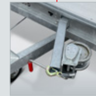
Flache Windenposition ermöglicht Durchfahrt nach vorne
