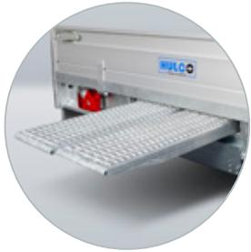
Zubehör; Auffahrampen aus Stahl oder Aluminium, in Kassetten
