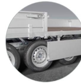
Geteilte Seitenwände ab 5 Metern Länge
