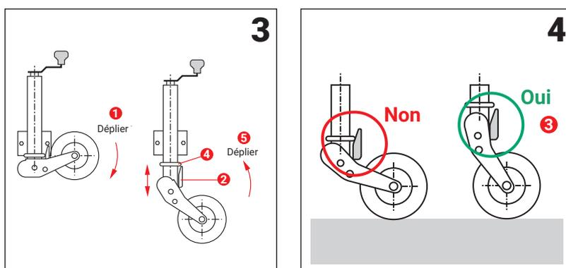
**Attention !** En remontant la roue jockey, veillez à ce qu'aucune partie de celle-ci ne soit au contact de la tringle de frein de la remorque. Le contact avec la tringle de frein, un mauvais fonctionnement du système de freinage est possible.
