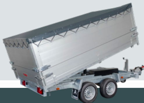
Avec des ridelles de rehausses de 70cm (hauteur intérieur 100cm) on peut utiliser le KSX pour toutes sortes de chargements.
