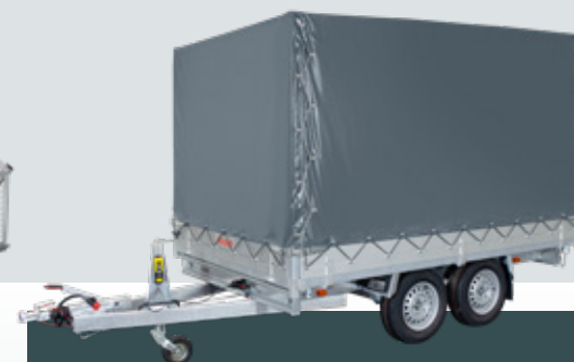
Un KSX avec une bâche haute, avec des hauteurs intérieures de 150 ou 180 cm, qui comprend une toile de bâche durable, un cadre en acier, des lattes en aluminium, des crochets de fixation et un cordon élastique.
